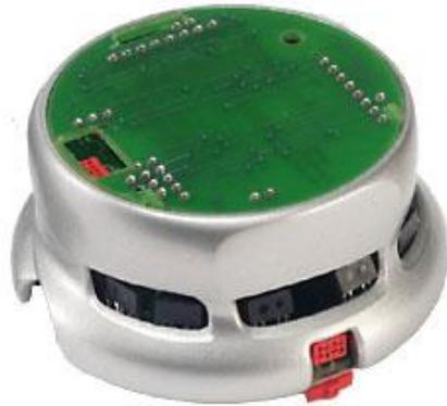
**Figura 2.3 :** Mini-robô Khepera II, cujo tamanho é de 80 mm x 30 mm.
