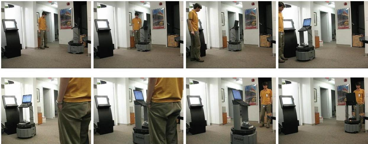
Figura 6.11: Robô seguindo uma pessoa em uma sala. A pessoa apenas se move quando o robô a alcança (Vídeo 6.1).
