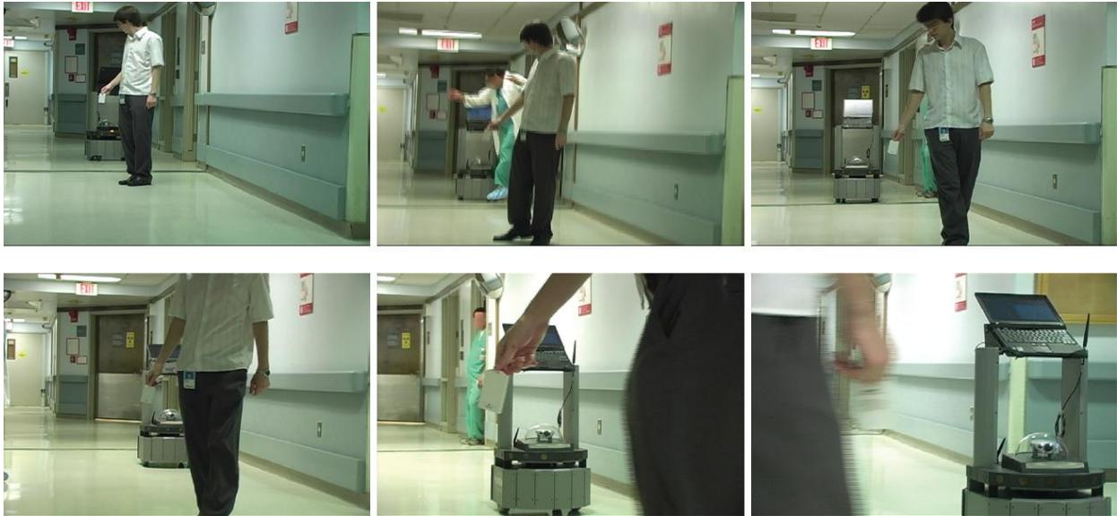
Figura 6.13: A pessoa carregando a tag é seguida continuamente pelo robô por um corredor de 20 metros (Vídeo 6.3).
