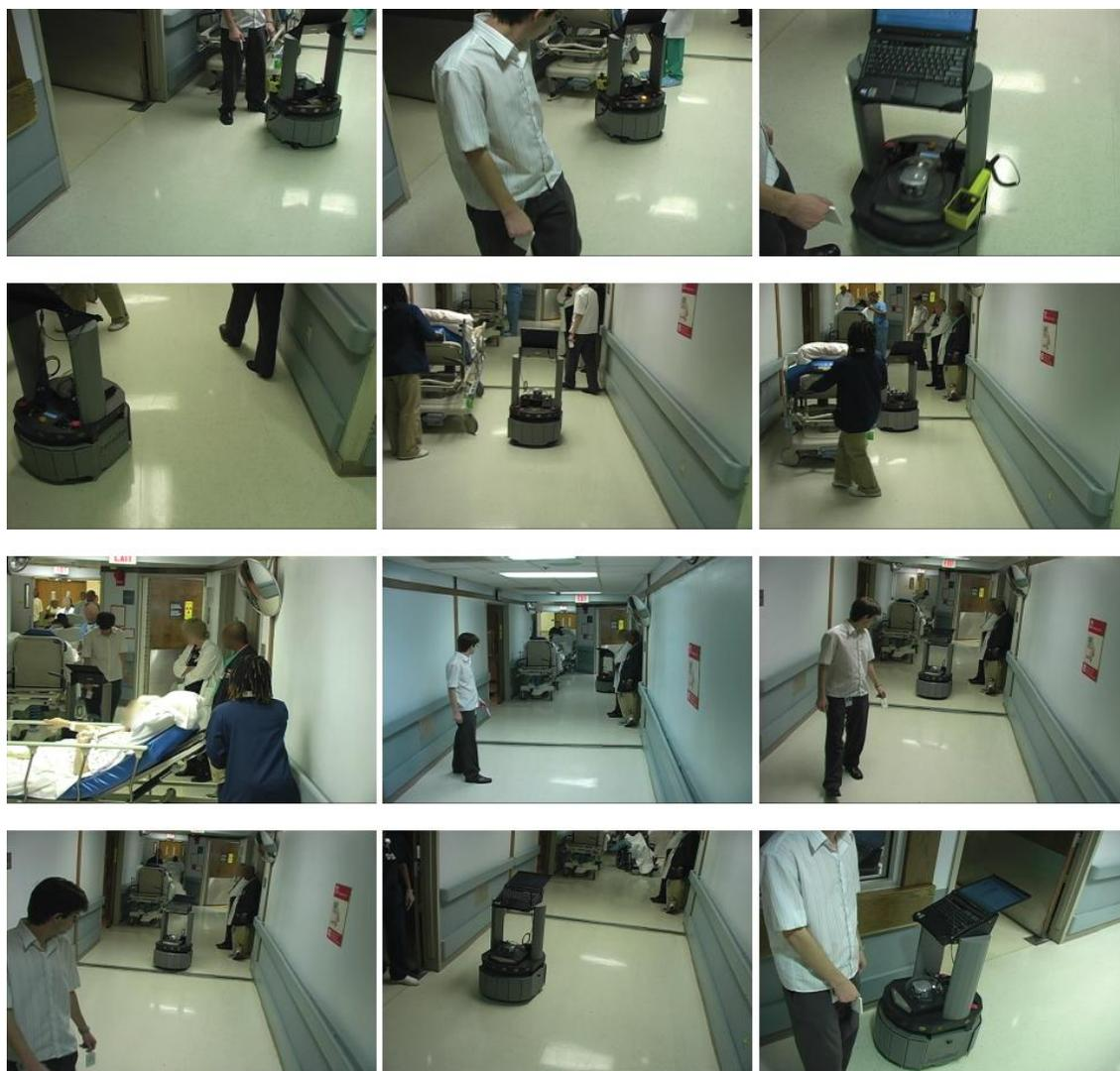
Figura 6.14: Experimento em que o robô faz rastreamento em meio a diversas pessoas e obstáculos no hospital (Vídeo 6.4).
