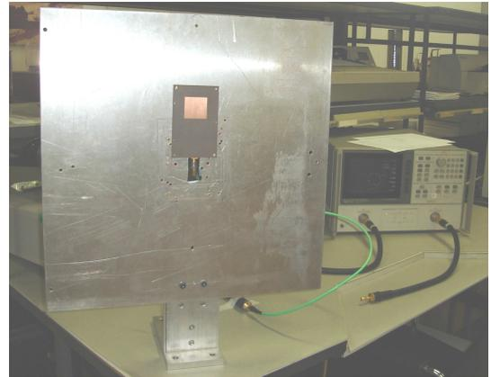
(b) Protótipo Fabricado e bancada de teste (*setup*)
