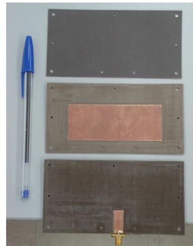
(b) Protótipo Fabricado
