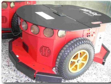
Fig. 7.1: Robô Pioneer 3-DX, com sonares e sensores de colisão nos para-choques. *Fonte:* <http://www.conscious-robots.com/>
