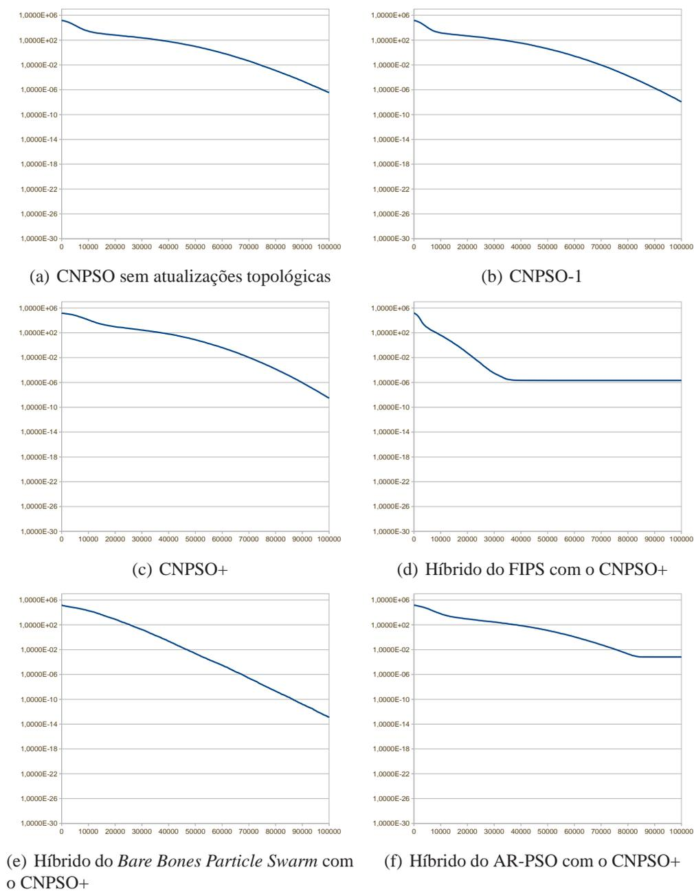
Fig. B.25: Gráficos de convergência dos CNPSOs para a função Sphere.
