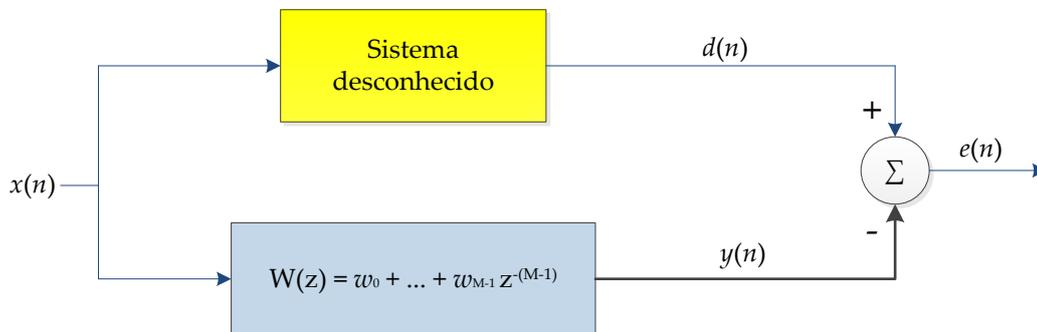
O modelo que vamos utilizar para a identificação do sistema é o de um filtro FIR com  $M$  coeficientes.
