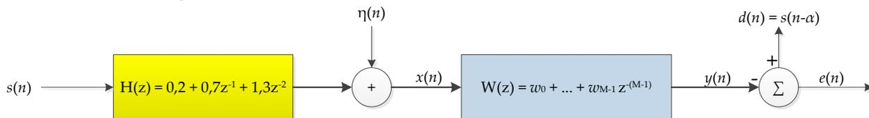
Assuma que desejemos projetar um equalizador com dois coeficientes através do paradigma de Wiener (ou seja, minimizando o erro quadrático médio entre a saída do equalizador  $y(n)$  e um sinal desejado  $d(n)$ , considerando o equalizador como um filtro FIR:  $W(z) = w_0 + w_1 z^{-1}$ ).
