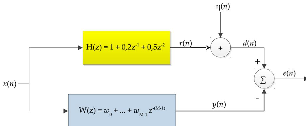
O modelo que vamos utilizar para a identificação do sistema é o de um filtro FIR com  $M$  coeficientes. Primeiramente, considere o arquivo dados\_identificacao\_ruido\_gaussiano.mat, que contém os vetores:
