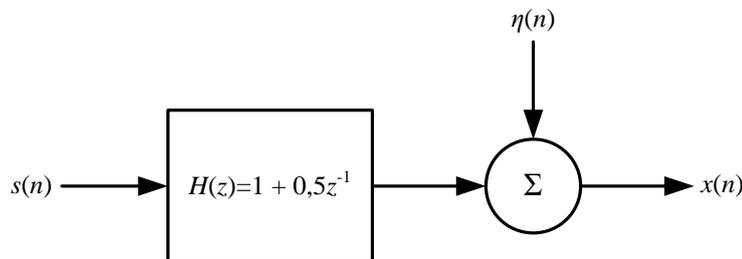
O canal introduz dois tipos de distorções no sinal transmitido: (i) interferência intersimbólica, modelada por um filtro com função de transferência  $H(z) = 1 + 0,5z^{-1}$ , e (ii) um ruído aditivo branco e gaussiano  $\eta(n) \sim N(0, \sigma^2 = 0,01)$ , de forma que o sinal recebido é dado por  $x(n) = h(n) * s(n) + \eta(n)$ . Sabendo que a sequência transmitida é i.i.d. e que cada amostra  $s(n)$  pertence a um alfabeto binário equiprovável  $\{-1; +1\}$ :
