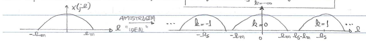
A partir do sinal amostrado  $x_a(t)$ , é possível recuperar (recompor) o sinal completo  $x(t)$  usando um filtro passa-baixas ideal, o qual captura a componente espectral centrada em  $\omega = 0$  ( $k=0$ ) e elimina os demais resplendores.
