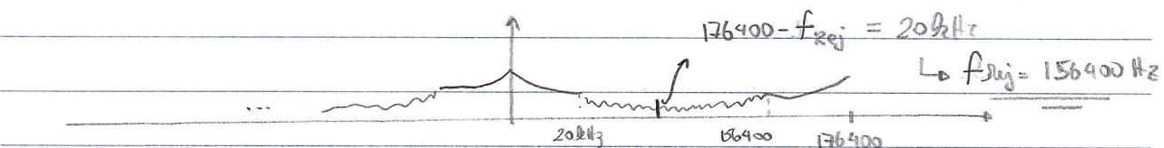
P/ não ocorrer aliasing na região de 20kHz, a cópia da réplica situada em 176400Hz não pode atingir 20kHz. Se usar um filtro anti-aliasing lento que deixe
