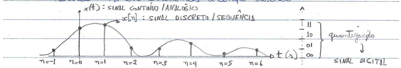
Ilustração esquemática de sinais a tempo discreto, cujos amostras possuem amplitudes contínuas (i.e., com precisão ilimitada).
