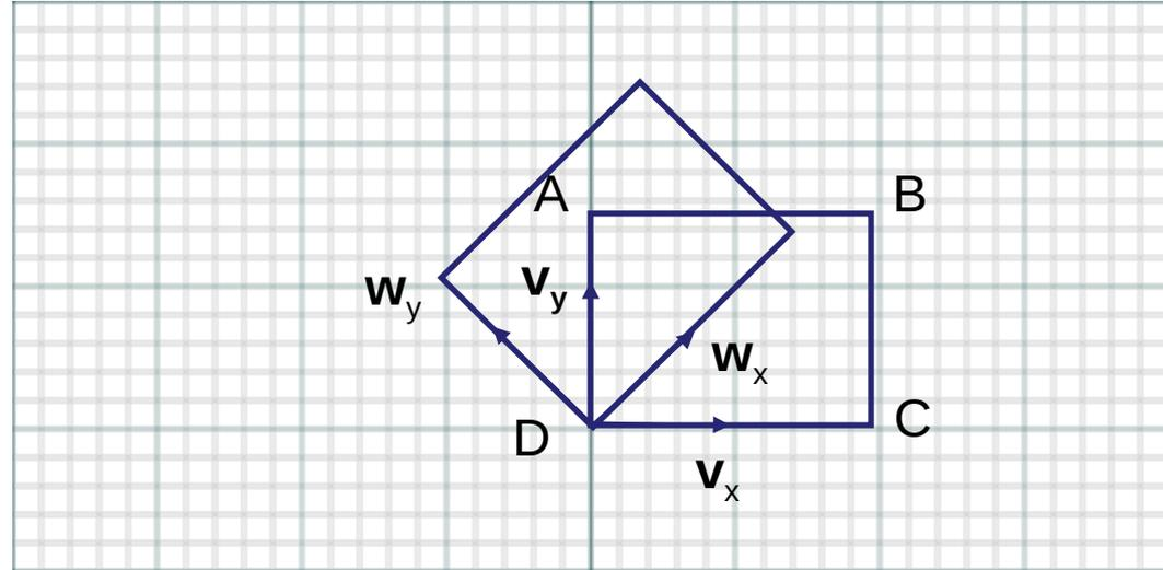
$$\begin{bmatrix} w_x & w_y \end{bmatrix} = T \begin{bmatrix} v_x & v_y \end{bmatrix}$$
