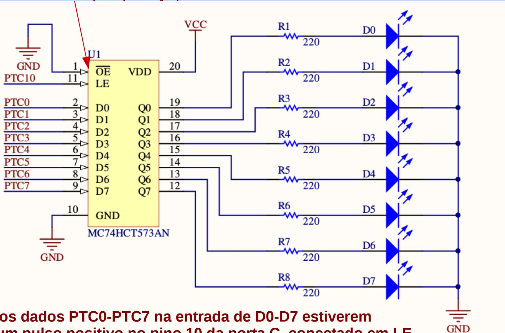
Quando os dados PTC0-PTC7 na entrada de D0-D7 estiverem estabilizados, um pulso positivo no pino 10 da porta C, conectado em LE, habilitará o *latch* para reter os valores D0-D7 nele.
