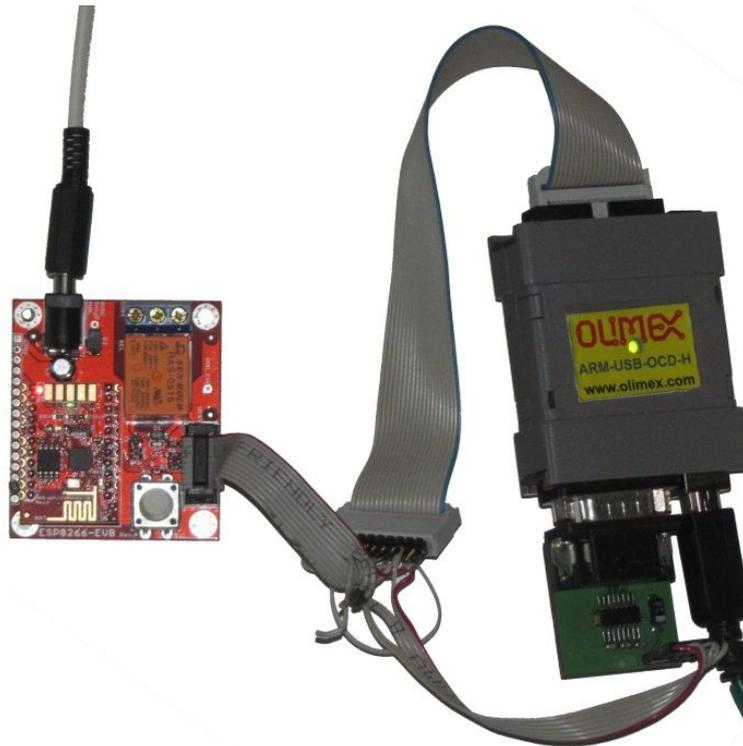
Figura 10.19: Depuração do ESP8266 com Olimex ARM-USB-OCD-H (Fonte: [61]).
