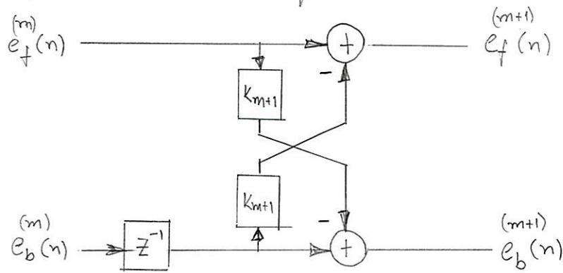
Concatenando blocos destes tipos, obtemos uma estrutura em treliça que calcula os erros de predição progressiva e retrograda de ordem  $M$ :
