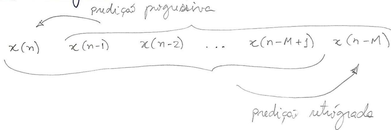
A predição retrograda linear consiste em estimar um valor passado do processo  $x(n)$  a partir de uma combinação linear de amostras mais recentes do processo. No caso específico de passo de predição unitário, deseja-se uma estimativa de  $x(n-M)$  a partir de  $x(n), x(n-1), \dots, x(n-M+1)$ :
