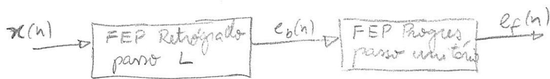
Preditor retrogrado com  $M_b$  coeficientes e progressivo de  $M_f$  coeficientes. Novamente considerando o caso ideal, o erro retrogrado é dado por:
