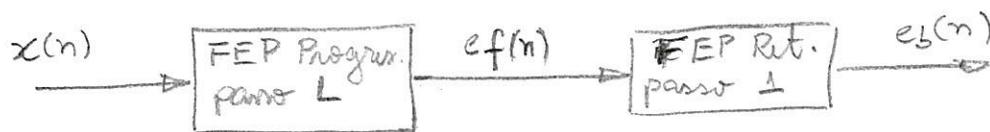
Predictor progressivo com  $M_f$  coeficientes e retrogrado de  $M_b$  coeficientes. Considerando o caso ideal, em que toda a redundância é removida, temos:
