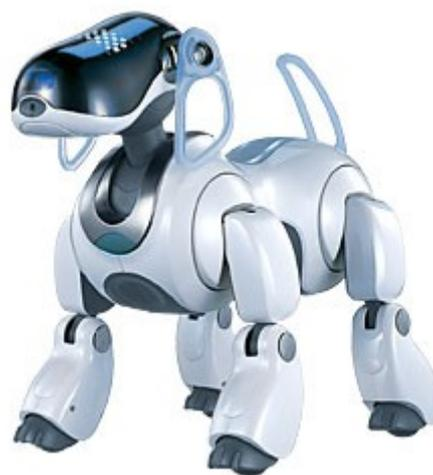
Figura 21 – Aibo: O Cão-Robô da Sony
