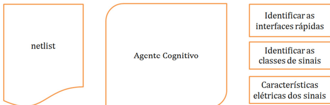
Fig.4: Classificações realizadas pelo agente cognitivo como processo intermediário para a definição de regras de roteamento e stackup .
