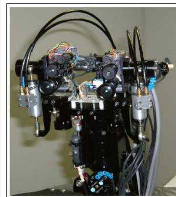
Figura 14. Sistema humanóide utilizado por Ude. O robô possui duas câmeras em cada olho.
