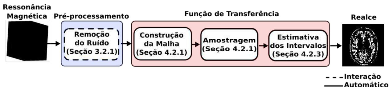
Figura 64 – Fluxo de controle da função de transferência.
