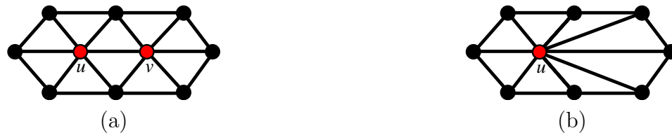
Figura 2.7: Contração do half-edge entre u e v , (u, v) \rightarrow u . A contração de um half-edge ocasiona a contração de uma aresta.
