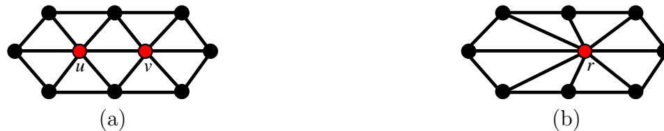
Figura 2.6: Contração da aresta entre u e v . A nova posição, r , é escolhida de forma livre.
