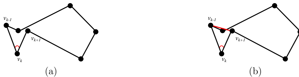
Figura 4.25: Cruzamento de arestas durante o preenchimento do buraco. O triângulo com vértices, (v_{k-1}, v_k, v_{k+1}) , é formado pois o menor ângulo interno encontrado foi entre as arestas (v_k, v_{k-1}) e (v_k, v_{k+1}) . Contudo a formação desse triângulo, ocasiona o cruzamento de arestas.
