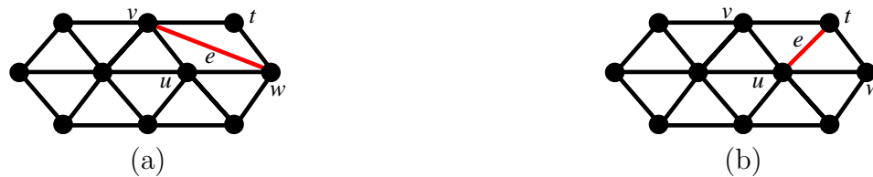
Figura 2.8: A aresta e é rotacionada para as extremidades as quais não pertencia.
