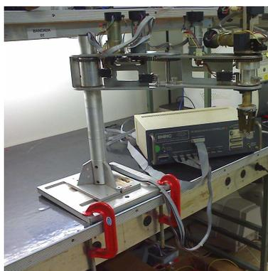
Figura 1. Rhino SCARA (robô e controlador).
