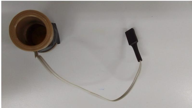
Figura 6: *Buzzer* piezoelétrico.
