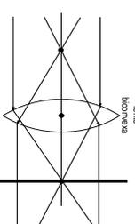
Dado um sistema de referência no qual o eixo óptico é coincidente com o eixo  $z$  e a origem com o centro óptico. Pode-se verificar que a imagem de um ponto  $P = [x^p \ y^p \ z^p]^t$ ,  $z > 0$  é  $P_p = [x^p \ y^p \ d]^t$  sobre o plano  $z = d > 0$
