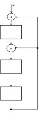
A cada circuito embaralhador, de entrada  $X$  e saída  $Y$ , existe um **circuito desembaralhador**, de entrada  $Y$  e saída  $Z$ , para recuperar o sinal original. Este circuito deve ter uma função de transferência tal que
